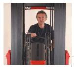
MÁSTIL DE VISIÓN LIBRE Los operadores tienen una excelente visibilidad hacia delante gracias a un mástil "hi Vis" con dos cilindros laterales.
